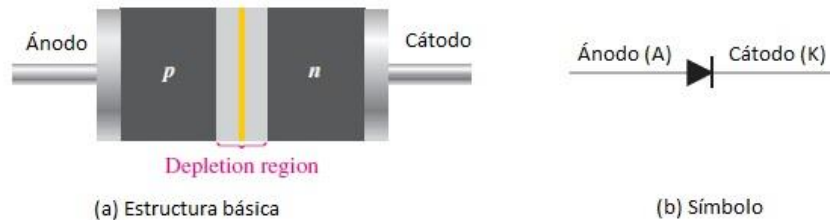
Figura 1.7.6. Representación simbólica de un diodo.
